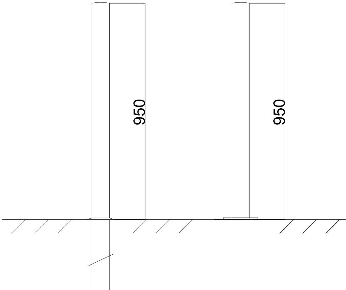
Ausführung: Rundrohr  $\varnothing$  70 / 76 / 102 mm
